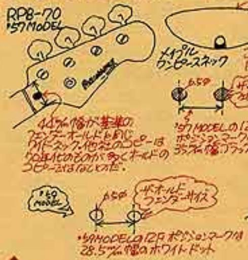
このP.U.、ソフトタイプが「Comfort Contoured Body」にフィットする。ヘッドストックは、ワイドネックも現在のワイドネックの幅に相当する。ワイドネックは、オールドプレジジョンベースが頂点を極めた時代、ワイドネックの「ワイドネック」の57 MODELと59 MODELにそれぞれ採用された。このワイドネックのオールドモデルはRPB-70に完全に再現された。
